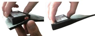
③コネクター面を残し、包み込むようにスポンジテープを折り込みます。
