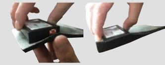
③コネクタ面を残し、包み込むようにスポンジテープを折り込みます。
