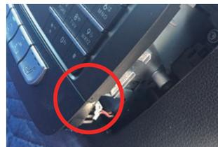
外したダクトの奥にあるトルクスねじを、付属のトルクスドライバーで緩め、ねじ部分のレバーを前方に（自分側へ引き寄せるように）引き出します。
