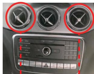
はじめに左右2カ所のエアコンダクトを取り外します。取り外しには付属のダクト専用工具を使用してください。
