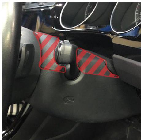
1：ワイパーレバー、ウイinkerレバー根元付近からカバーを上方向に持ち上げて外します。
