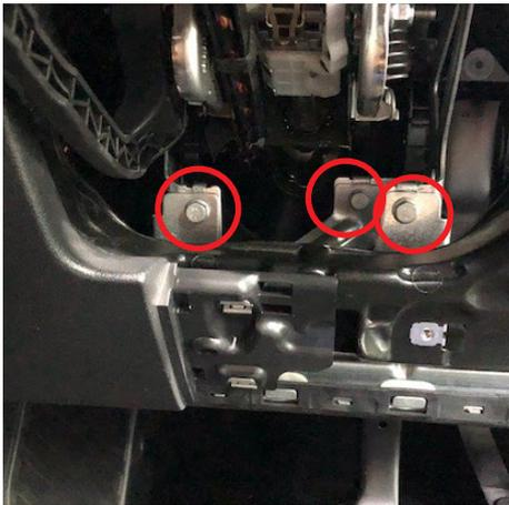
5：運転席ニーエアバッグユニットの固定ボルト 3本を取り外して下におろします。
