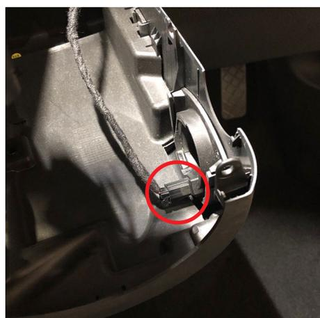
4：コラムロアカバーのリードコイルアンテナのコンネクタを外します。
