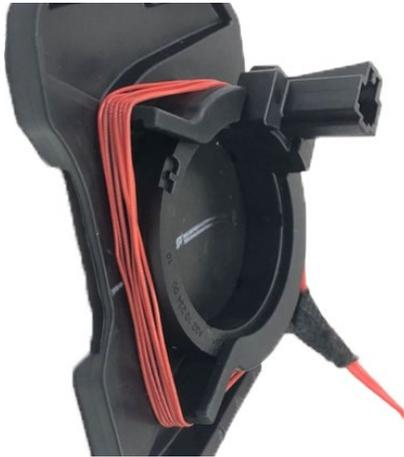
1：リードコイルアンテナをカバーから取り外し、「キーアンテナ用コイル線」を巻き付けます。
