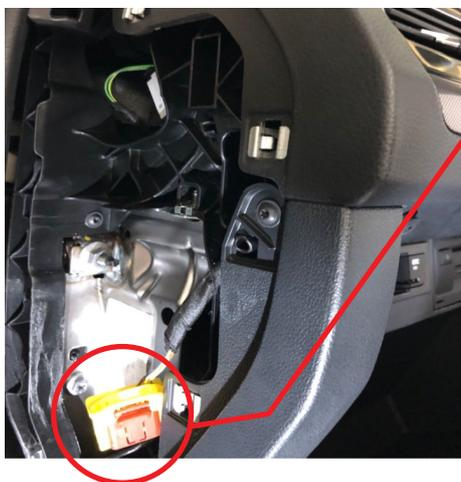
2：「オーディオ脱着工具」を使い、ナビ本体を引き出し、接続コネクタを全て取り外します。
