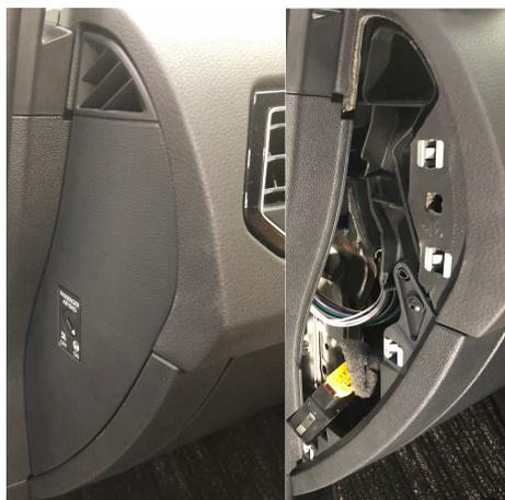
※助手席エアバッグオフ用キースイッチを取り外し、E2START動作確認時まで接続しておきます。
