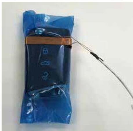
1：リモコンキーの内蔵電池を取り外し、キーを養生します。
