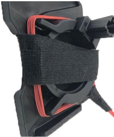
配線がずれ外れる場合があるため、巻き付け完了後はテープ等で固定します。
