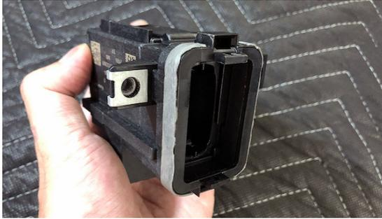
写真の様にキーシリンダーにテープを貼り、アンテナ線を巻き付けます。
