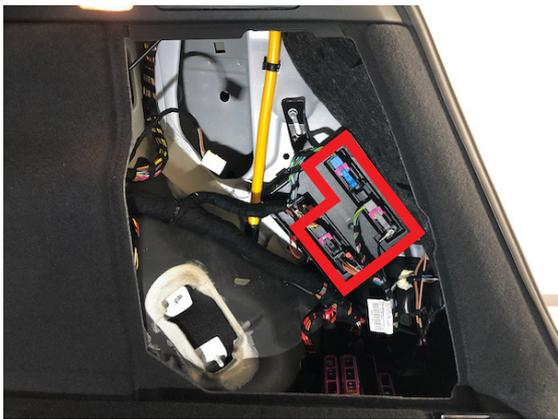
写真の水色、灰色および黒色コネクタに弊社 P&P ケーブルを割り込ませて接続します。
