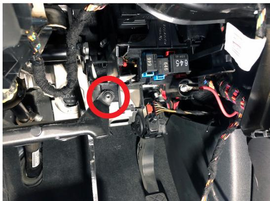
エアコンダクトと共締め T25 スクリューを外し、リレーホルダを取り外します。
