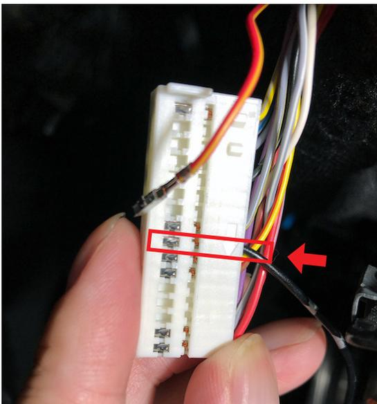
外した箇所に弊社 P&P ケーブルのハザード端子を差し込みます
