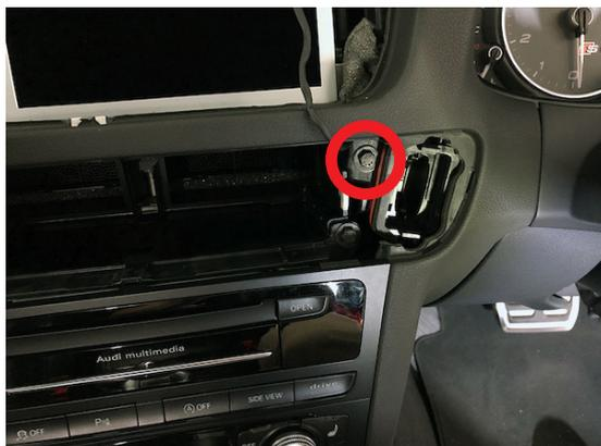
8mm ナットを取り外し裏側に押し込むようにして、キーシリンダーを取り外します。
