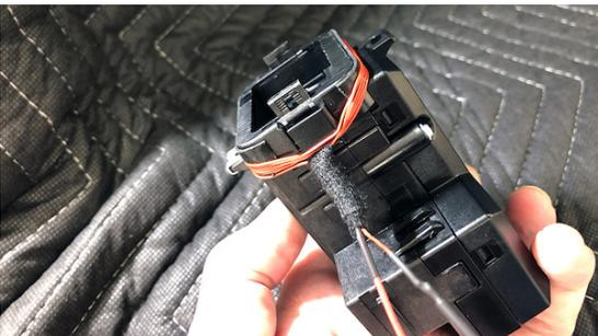
送信コイル延長ケーブルと接続し、元の場所に格納します。
