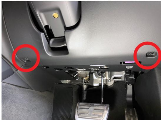
2箇所の8mm ナットを取り外します
