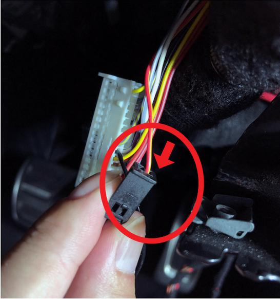
先ほど抜いた赤 / 黄色の端子を、弊社 P&P ケーブルに付属のコネクタピン端子 1 に差し込みます。
