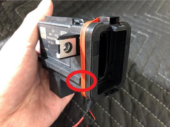
元に戻す際に干渉しますので、巻き付ける線は必ずフラットになるように巻き付けて下さい。特に赤丸の部分は干渉しやすいので注意して下さい。
