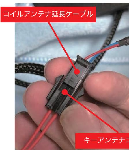
左写真は「キーアンテナコイル線」と「コイルアンテナ延長ケーブル」を接続した写真です。
