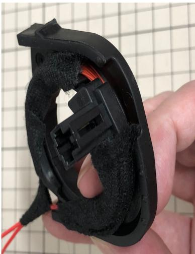
配線がずれ外れる場合があるため、巻き付け完了後はテープ等で固定します。
