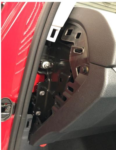
3：グローブボックス固定ボルトを全て外します。
