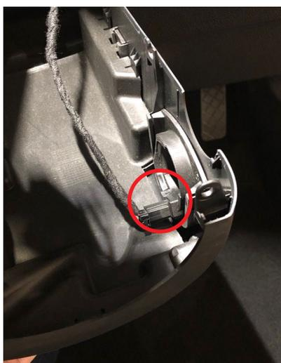
4：コラムロアカバーのリードコイルアンテナのコンネクタを外します。
