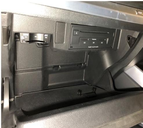
1: 「オーディオ脱着工具」を使い、ナビ本体を引き出し、接続コネクタを全て取り外します。
