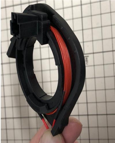
1: リードコイルアンテナをカバーから取り外し、「キーアンテナ用コイル線」を巻き付けます。
