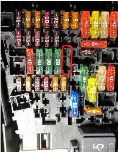
1：ヒューズボックスのF28(常時電源)に、「P&Pケーブル電源ヒューズ配線」を差し込みます。
