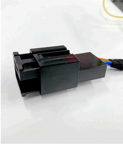
3：3層構造になっている「P&Pケーブル コネクタ①」から、作業に必要な「コネクタ②」を取り外します。
