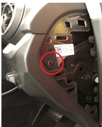
2：ロアカバー固定ボルトを3箇所外し、ロアカバーを手前に外します。
