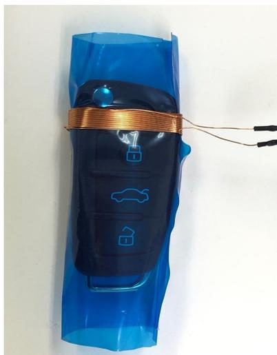
1：リモコンキーの内蔵電池を取り外し、キーを養生します。
