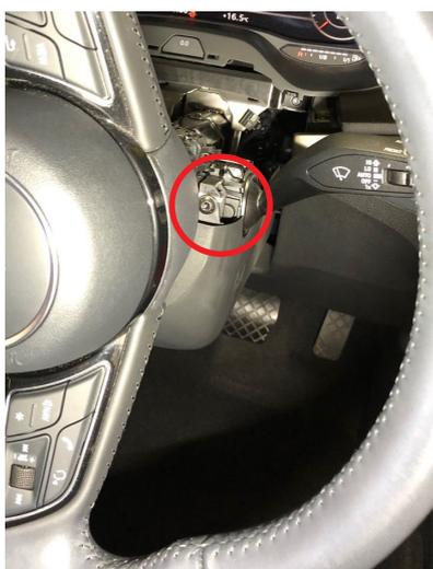
3：コラムロアカバーの取り付けボルトを3箇所外します。
