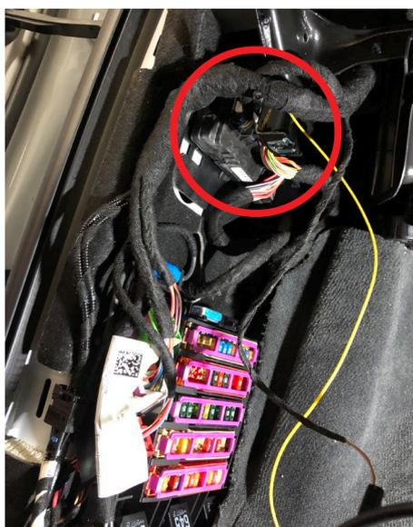
キックパネル内のこの位置（赤丸）に取り付けられているオンボードサプライコントロールユニットの、一番手前に接続されているコネクタを取り外します。
