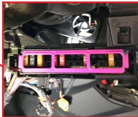
ヒューズホルダーのロックを解除し、専用取付ケーブルの配線（黄色）を差し込みます。
