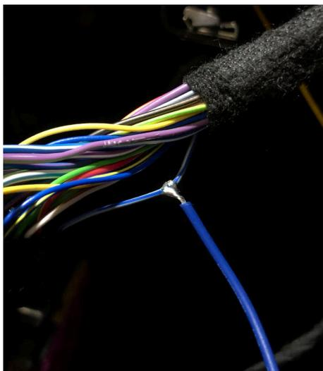
すでに配線が接続されている場合は、製品青色配線の端子部分をカットして、37番の配線に直接半田付けします。
