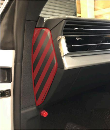
センターコンソール側のグローブボックス下のカバーを取り外します。
