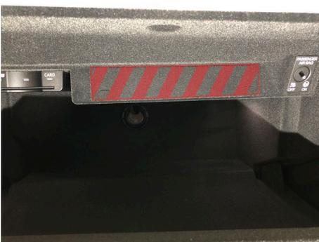
ETC車載器を取り外し、固定ボルトを全て外し、グローブボックスを取り外します。
