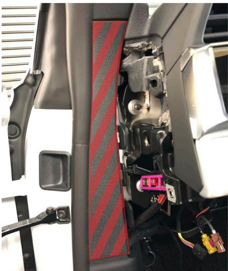
サイドステップパネルのフロント側を上を持ち上げて、キックパネルのトリムを取り外します。
