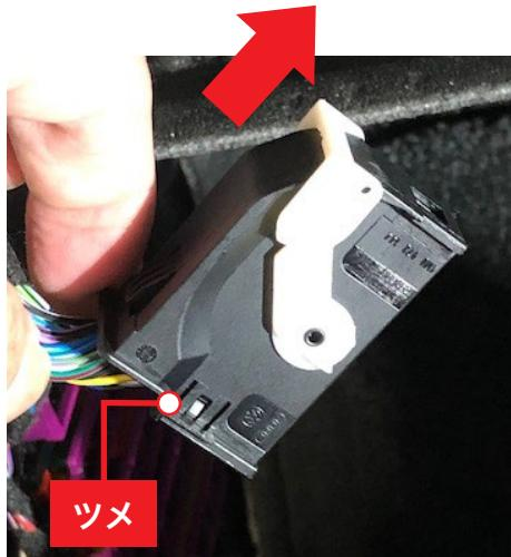
外したコネクターのツメを解除し、矢印方向にコネクターカバーを外します。
