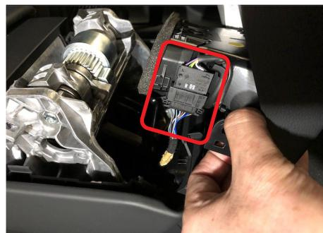
後席用エアコン吹き出し口を取り外し、配線も取り外します。
