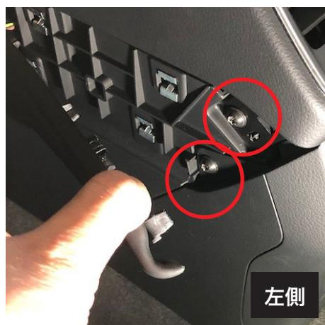
左右のトリムを持ち上げるとトルクスネジが確認できます。
