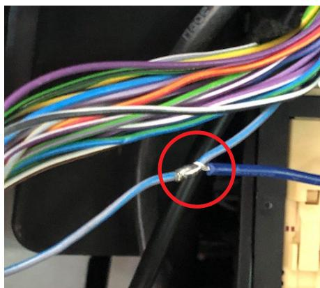
使用されている場合は、専用取付ケーブルの配線(青色)の端子部をカットして、37番の配線に直接半田付けします。
