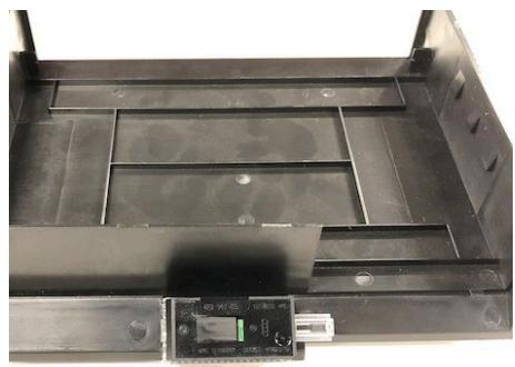
左写真は、ライト取り付け後の専用取付BOX（ロアパート）を裏側から見たものです。
