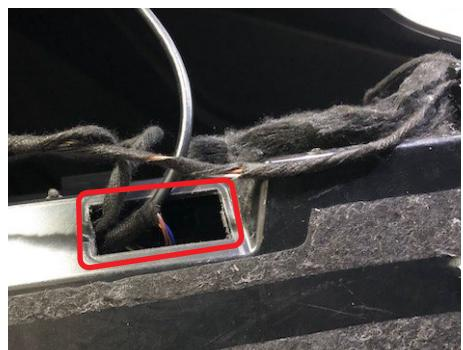
空いた穴から、グローブボックス内に専用取付ケーブルを引き込みます。
