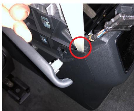
左写真のようにトリム剥がしなどを差しこみ、ツメを解除して外します。
