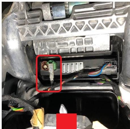
専用取付ケーブルのコネクター(茶色)を、左写真の空いている箇所へ接続します。
