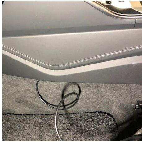
専用取付ケーブルを、グローブボックスからセンターコンソールの内側を通り、後席用エアコン吹き出し口の裏側まで通します。
