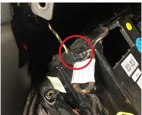
引き出したグローブボックス裏の接続コネクターを外します。
